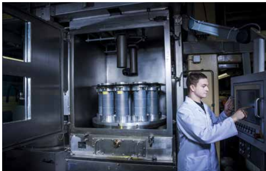
Vorbereitung für das Gießen von Explosivstoff in die Gefechtskopfgewehäuse
